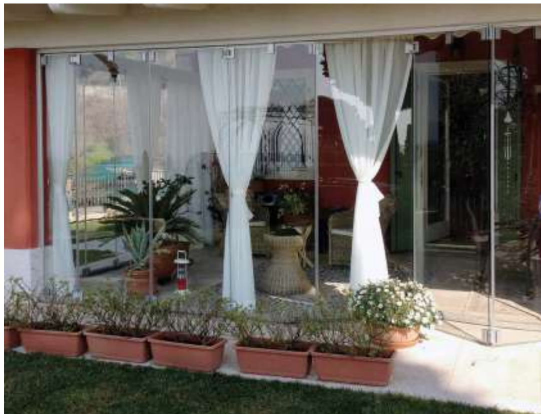
Chiusura pompeiana esterna con sistema a libro. Per questo progetto è stato utilizzato vetro trasparente temprato.
