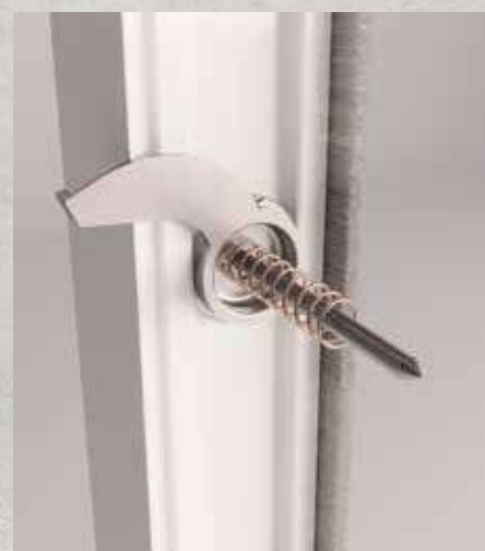
CHIAVETTA DI SICUREZZA GIREVOLE PER LA REGOLAZIONE DEL FUORI SQUADRO DA 0 A 15 MM. PER MONTAGGIO IN LUCE.
