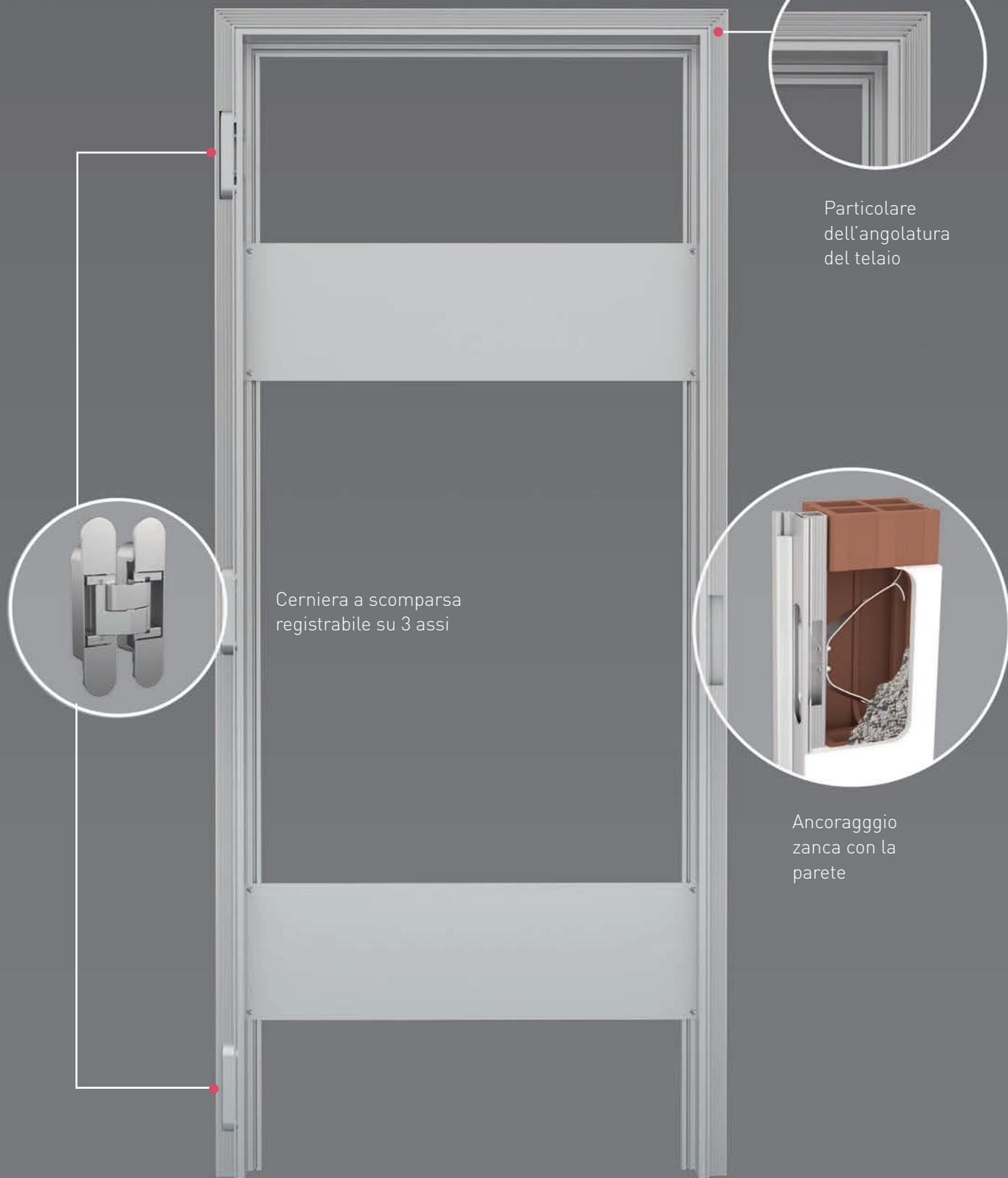
Porta filomuro apertura battente, applicabile su pareti in muratura e cartongesso di qualsiasi spessore, disponibile nelle misure standard e su misura. La fornitura di serie comprende: telaio in alluminio estruso da 50 mm in finitura ruvida tipo intonaco sovraverniciabile completo di staffe di fissaggio.
