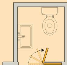
Il modello ECLISSE NOVANTA invece permette a mezza porta di scomparire dentro il muro e all'altra mezza di aprirsi a battente. Et voilà, problema risolto!
