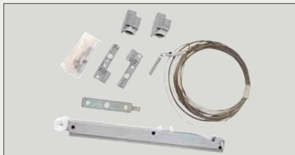
Questo accessorio consente di aprire e chiudere simultaneamente due porte muovendo una sola anta alla volta. Esclusivamente per porte in legno con larghezze da 600+600 mm a 1000+1000 mm. Fornita di serie con ECLISSE BIAS® che rallenta la chiusura ed accosta i pannelli porta. Per porte con peso superiore ai 25+25 kg (fino ad un massimo di 50+50 kg), ECLISSE BIAS® rallenta il movimento in chiusura.
