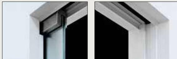
**VITRO** è la veletta in acciaio inox che ti permette di installare qualsiasi porta in vetro sui modelli della linea ECLISSE SYNTESIS®. VITRO comprende gli elementi verticali che adattano il controtelaio allo spessore ridotto delle porte in vetro (10 mm).
