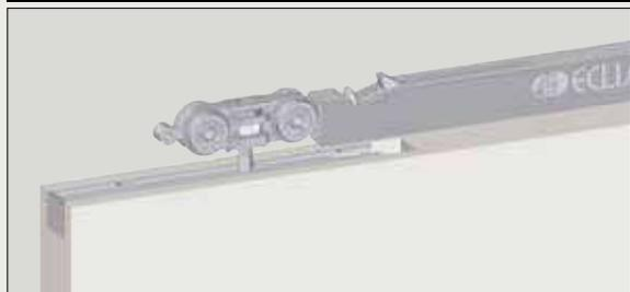
**ECLISSE BIAS®**, Built-In Anti-Slam, è l'ammortizzatore per porte scorrevoli a scomparsa che scorre all'interno del binario. Dotato di un pistone ad olio che rallenta e accompagna dolcemente la porta in fase di chiusura. Offre un buon potere di rallentamento per porte sino a 100 kg di peso.
