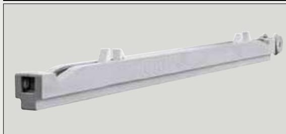
**ECLISSE BIAS® DS**, Built-In Anti-Slam Double Side, è l'ammortizzatore bidirezionale per porte scorrevoli a scomparsa invisibile dall'esterno. Rallenta e accompagna dolcemente la porta sia in fase di apertura che di chiusura. Offre un buon potere di rallentamento per porte sino a 100 kg di peso (solo per pannelli porta con luci di passaggio maggiori di 700 mm).
