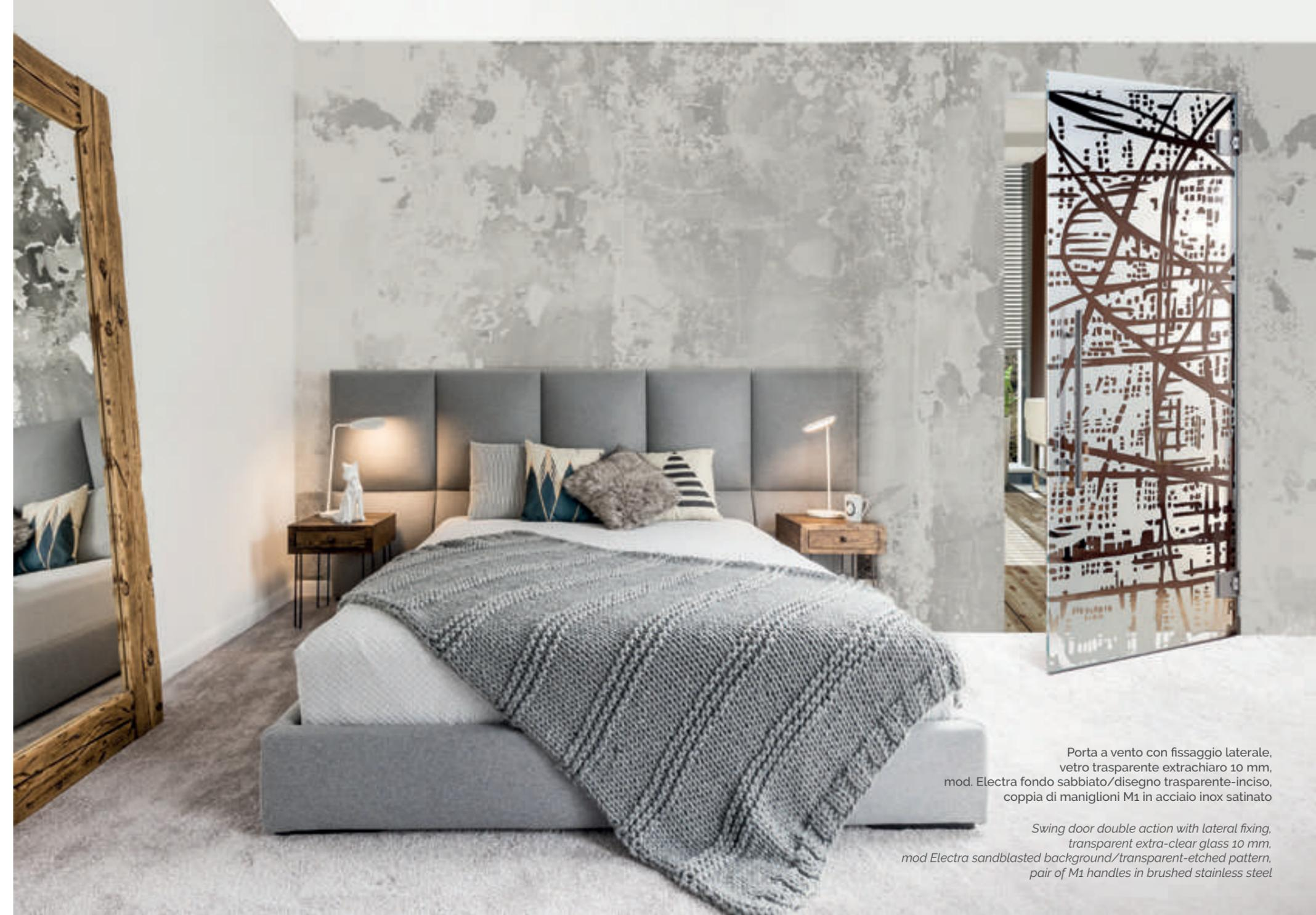
Porta a vento con fissaggio laterale, vetro trasparente extrachiaro 10 mm, mod. Electra fondo sabbato/disegno trasparente-inciso, coppia di maniglioni M1 in acciaio inox satinato
