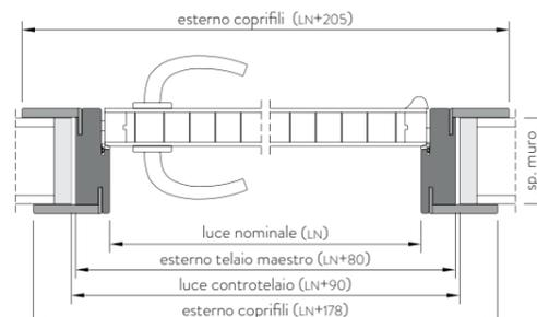
Sezione telaio orizzontale
