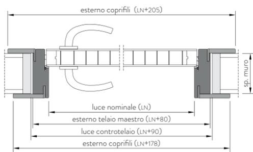
Sezione telaio orizzontale
