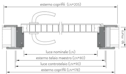
Sezione telaio orizzontale
