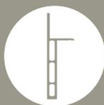
La soluzione **Syntesis® Battiscopa** si esegue predisponendo l'incavo per il battiscopa e collocando degli appositi profili in alluminio forato in fase di costruzione della muratura, prima di eseguire l'intonacatura e la posa del pavimento. **Syntesis® Battiscopa** realizza la perfetta combinazione armonica attraverso l'abbinamento con i modelli di **Syntesis® Collection**, dalle porte a battente filomuro ai sistemi per porte a scomparsa privi di cornici.
