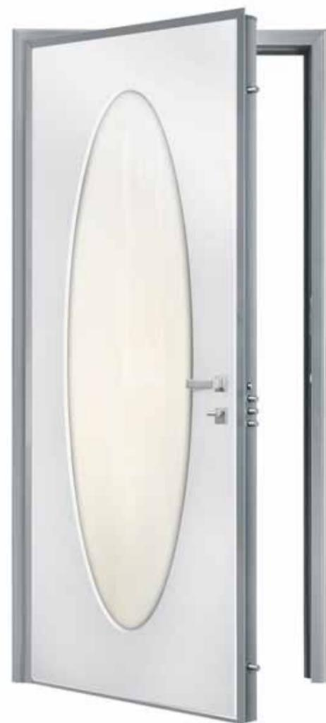
SULLE PORTE BLINDATE A VETRO ALIAS NON SONO PRESENTI CORNICI FERMA VETRO MA VENGONO PANTOGRAFATI I PANNELLI DI RIVESTIMENTO INTERNI ED ESTERNI IN MODO DA DETERMINARE LA SAGOMA DELLA FINISTRATURA. FRA IL VETRO E IL PANNELLO È PRESENTE UNA GUARNIZIONE ISOLANTE.
